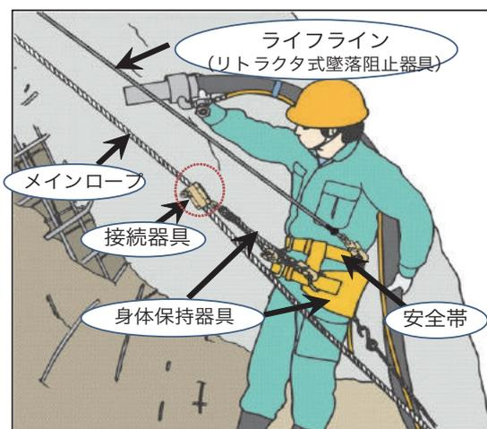
のり面保護工事でのロープ高所作業の例
