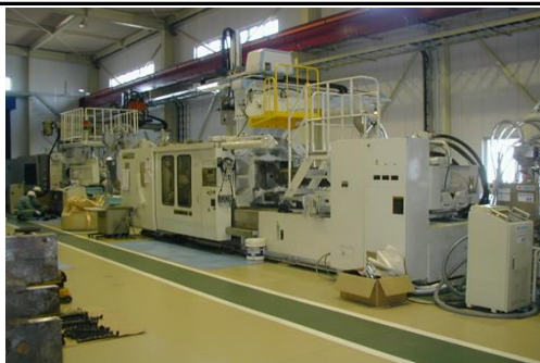
成形工場の成形機 完成した金型を取り付けて量産
