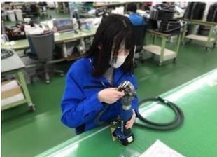
太物ケーブルを中心に、はんだ付け作業や圧着作業に取り組んでいます。色んな製品を作ることによって自分の出来る幅が広がり作業が楽しく感じます。特に圧着作業は様々な工具を使い、手動であったり半自動であったりその圧着するピンに合った方法で作業をするので、かsherる時は毎回緊張しますがミスなく出来たときは達成感を感じます。
