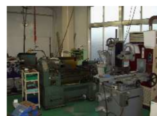
研磨機により金型の切削加工を行います。
