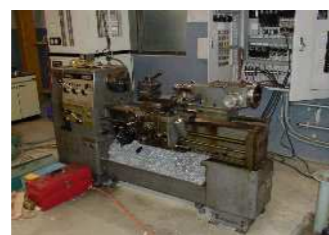
材料取りが行われたら、旋盤にて切削加工を行います。
