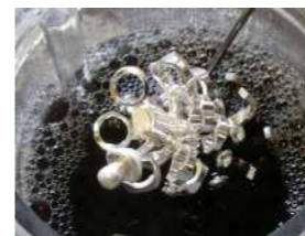
電解研磨を施し、酸化膜を除去した後、磁気パレル研磨で全体を磨きます。
