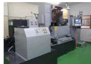
放電加工機などし金型を製造 (機械の一例)
