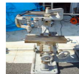
金型に彫刻機で彫刻します。
