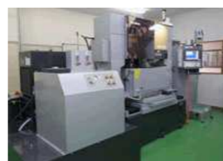
放電加工機にて、金型の表面を削るなどの加工を行います。
