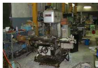
フライス盤にて金型の製造のための材料取り (所定の大きさに金型材料を切断等をする。)を行います。
