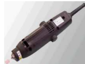
リュータはやすりと同様に、細部等を研磨する電動工具です。
