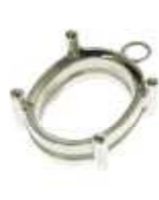
石枠を型取りした後、爪の製作をします。指輪を造る場合は、その後、腕の製作をします。パーツ等を寄せロウ付けします。
