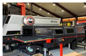
ファイバーレーザー複合機を使用して、金属素材を部品の形状に合わせて切り抜きます。
