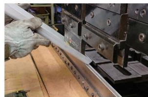
バンディングマシンを使用して折り曲げ、立体形状にしていきます。
