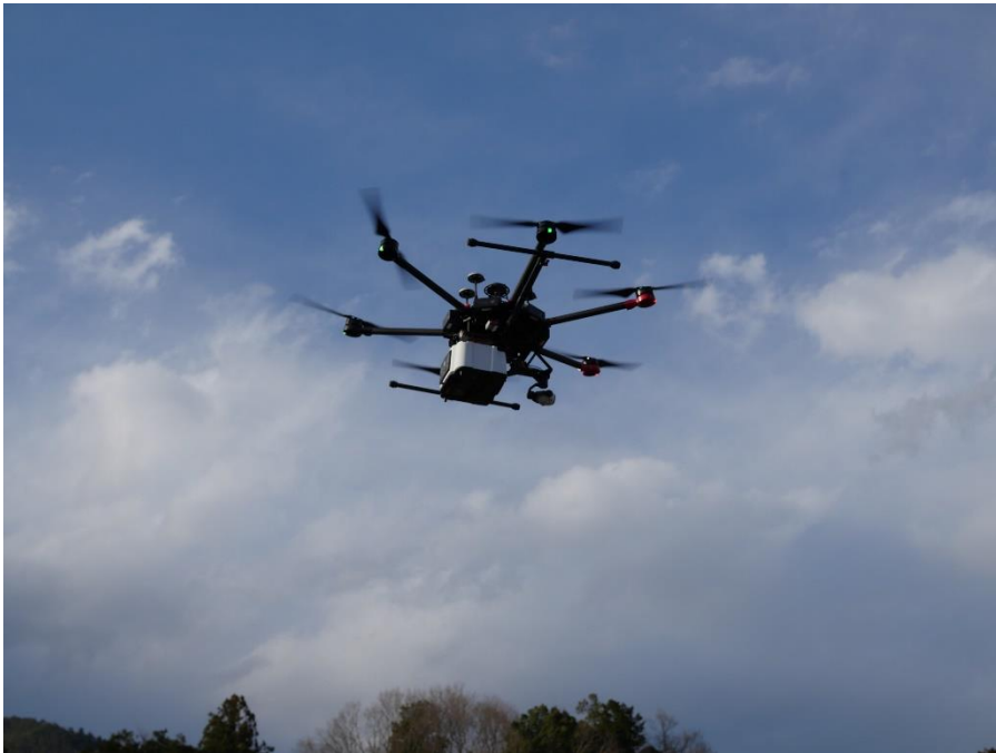
水中計測ができ る UAV 搭載型グ リーンレーザス キャナー
