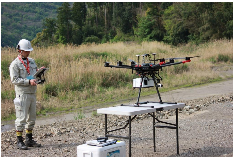
UAV レーザ測量
