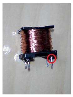
銅線の両端(コイルの巻き始めと巻き終わり)を、足の部分に線をからげる工程。
