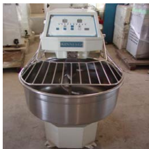
混合等を行う機械(例:ミキサー)
