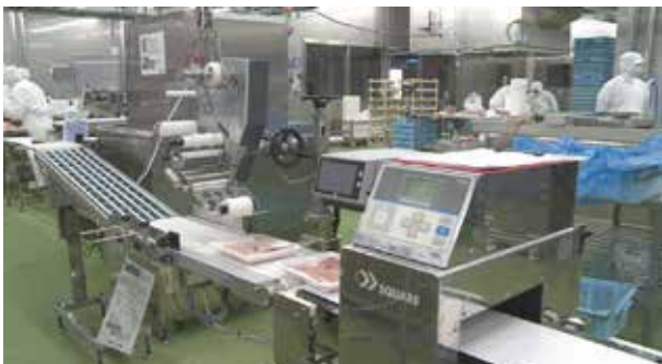
パックされた食肉は金属探知機、計量・値付機を経て出荷ターミナルへと運ばれる。
