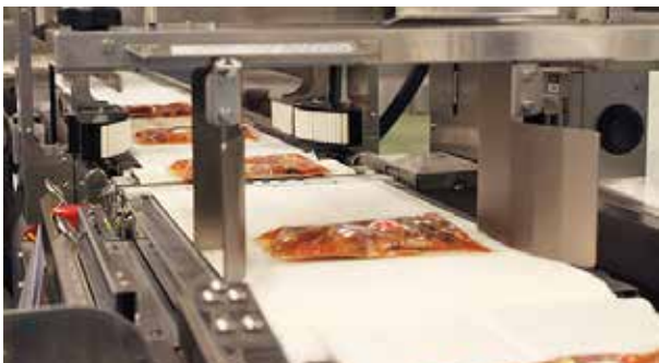
金属探知機、POPラベル貼付、原料表示ラベル貼付、ウェイトチェックまでが自動化されたライン。
