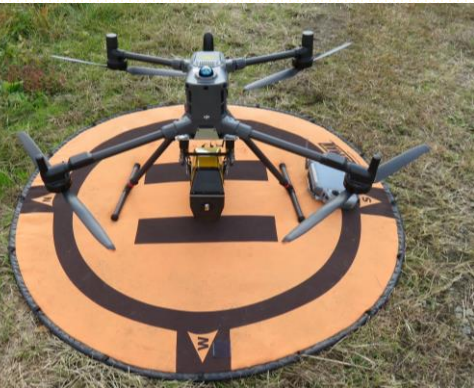
最新鋭のUAVレーザー測量機
