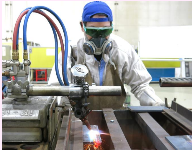
自動ガス切断
