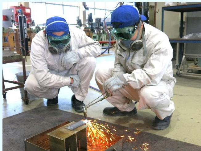
ガス切断実習
