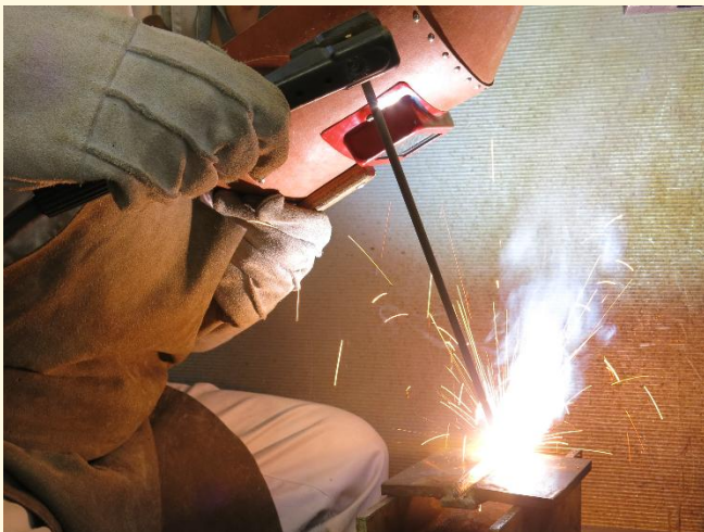
溶接実習（被覆アーク溶接）
