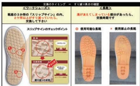
転倒防止のため、耐滑性の高いワークシューズ（耐滑区分5、動摩擦係数0.4以上）を導入しているが、更に、靴底の摩耗により耐滑性能が落ちることを防止するために、毎年定期的に靴底を点検。取組シートを作成して掲示している。
