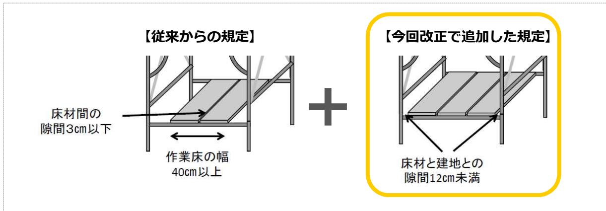
※ 鋼管足場用の部材と付属金具の規格（昭和56年労働省告示第103号）で、床付き布わくの床材の幅は24cm以上とされていることから、はり間方向での建地と床材の両端との隙間の合計幅が24cm以上であれば、さらに床材を敷き、床材と建地との隙間をふさぐことが可能であることを踏まえ、可能な限り床材と建地との隙間をふさぐことを目的に、それ以上追加的に床材を敷くことができなくなるまで床材を敷くようにするための要件を定めたものです。
