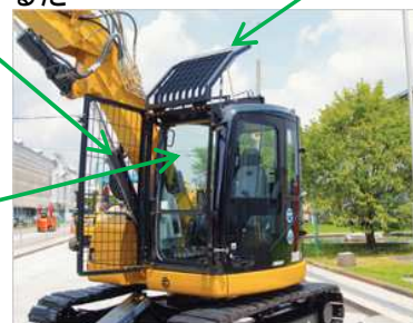
運転室周りの飛来物防護設備の例
