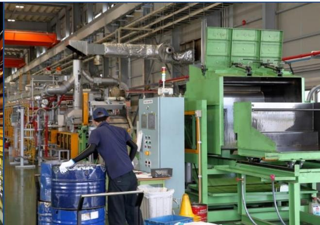
金属製品を熱処理炉に投入
