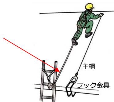
※はしごの踏み機は墜落阻止するための強度が不十分な場合があるので、落下時の荷重が踏み機ではなく、支柱に伝わるようにする。
