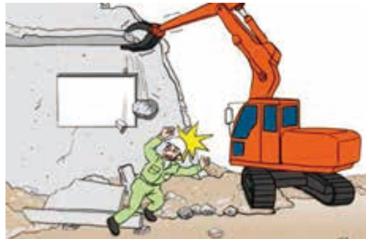
解体作業での飛来・落下
