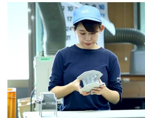
仕上げ検査作業
