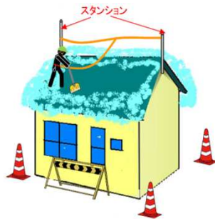
ステーションを設置して親綱を張る
