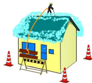
屋根の反対側の固定物に親綱を結ぶ
