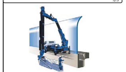
「橋梁点検用高所作業車」の例 ※3
