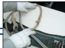
安全帯の点検 ※7
