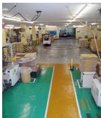
短期雇用の作業者がフォークリフトと接触する災害が発生したため、4つの色分けルールを決め表示した
