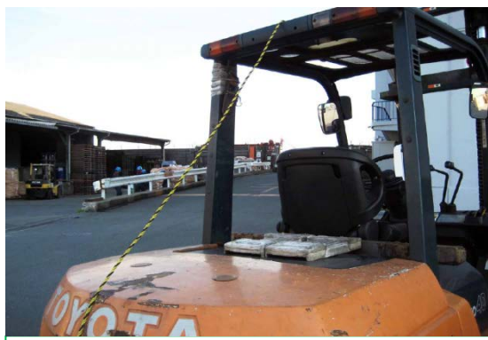
フォークリフトの後方にトラロープを張り、トラロープまで振り向いて確実に後方確認することにした
