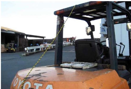
フォークリフトの後ろにトラロープを張り、トラロープまで振り向いて確実に後方確認することにした
