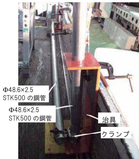
図 3-17 支柱下端を鋼管で連結した状態
