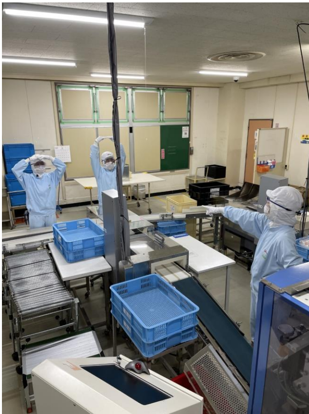
事例4：指差呼称（機械運転開始時等に、機械操作者は指差呼称をし、関係作業者の合図を確認したうえで操作を行うもの）
