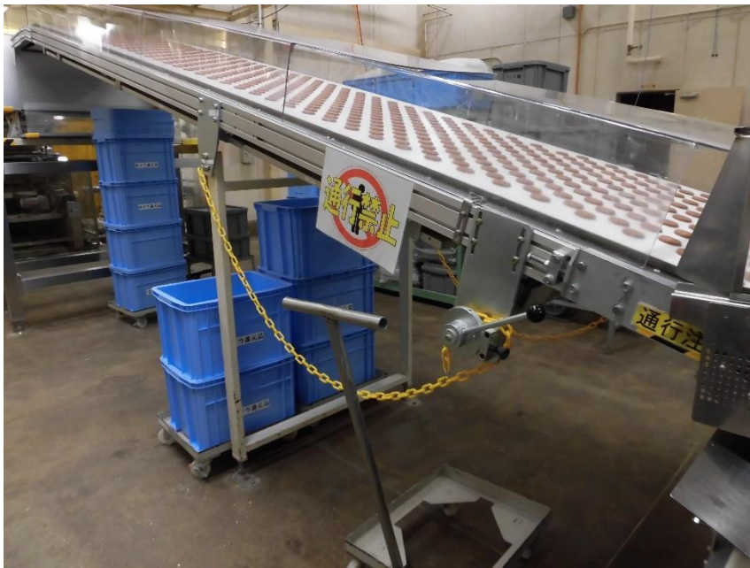
事例3：コンベアーの可動部分の囲い（上部は透明なカバーを設置）
