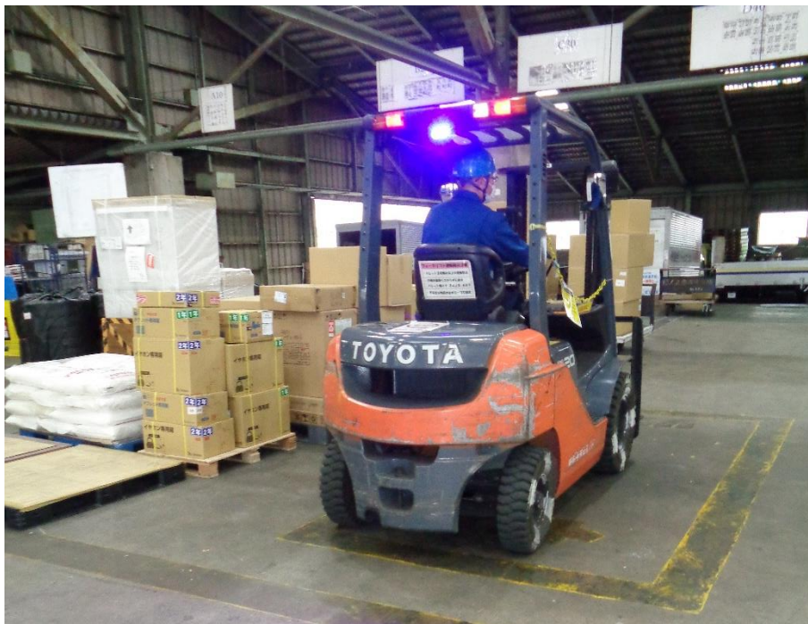
事例3：バック時のバックブルーライトの点灯
