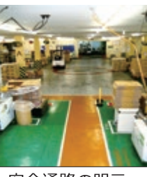
安全通路の明示
