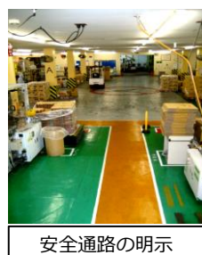
安全通路の明示
