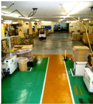
安全通路の明示
