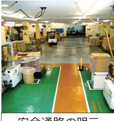
安全通路の明示
