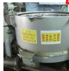
機械設備に貼られた注意事項
