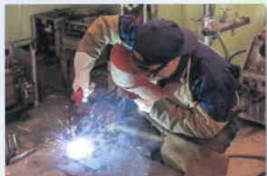
被覆アーク溶接
