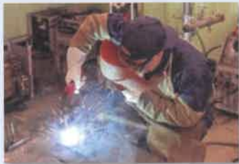
被覆アーク溶接
