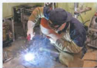
被覆アーク溶接
