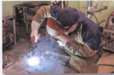
被覆アーク溶接
