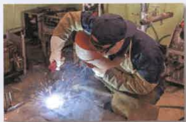
被覆アーク溶接
