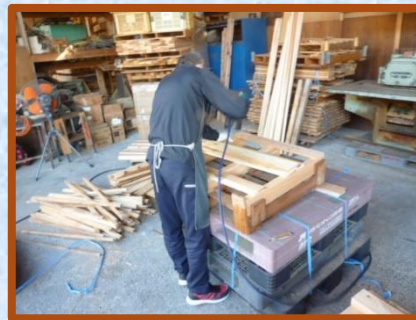
▲手動による釘打、組立作業
