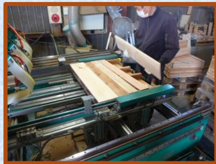
▲組立、自動釘打作業
