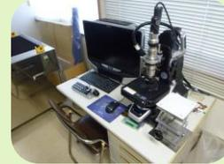
プリント基板の目視検査から、メッキ薬液の濃度検査、顕微鏡によるメッキ被膜の厚み検査など品質保証業務全般を行います。
