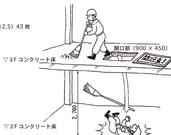
開口部養生ブタをはずしていた
