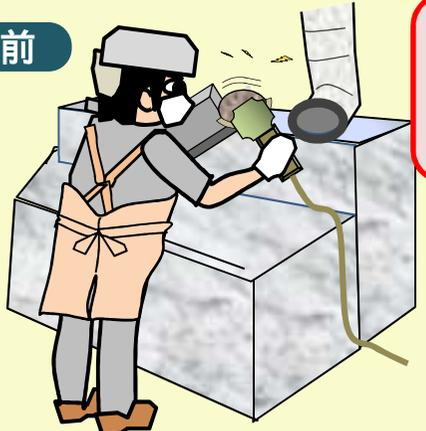
発生した粉じんを十分に捕捉できる有効な局所排気装置を設置する。
