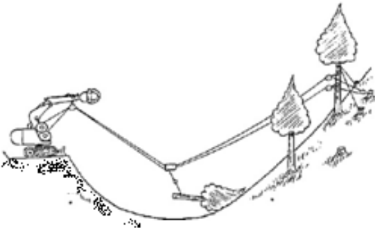
簡易架線集材装置
