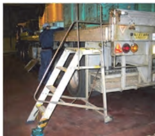
（写真2）昇降設備
