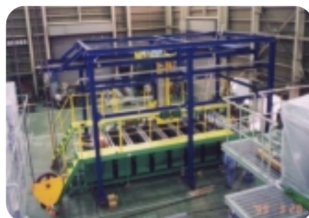
自動メッキ装置
