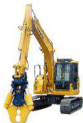
コンクリート圧砕機（コマツ製、同社提供）とアタッチメントのコンクリート圧砕具（大割）
