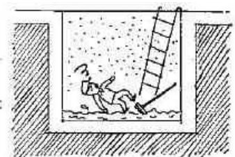
汚泥をかきませ硫化水素発生
