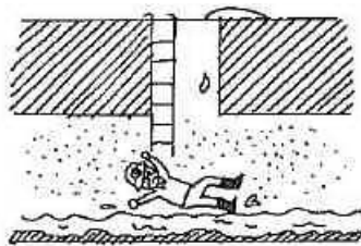
マンホール内に硫化水素滞留
