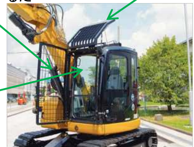
運転室周りの飛来物防護設備の例
