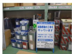
使用機材：工事看板や白線引き用機器、塗料などが保管されています。白線引きは幅によって使い分けます。
