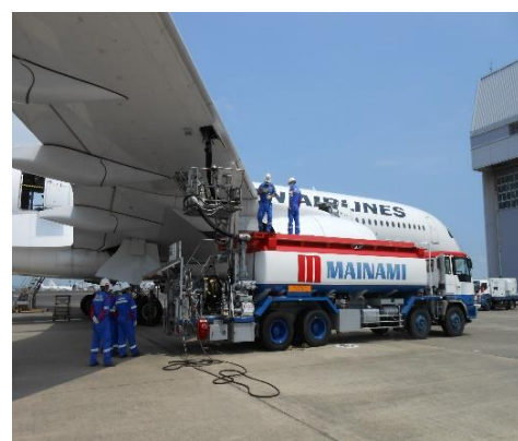
【航空機からの抜油作業】
