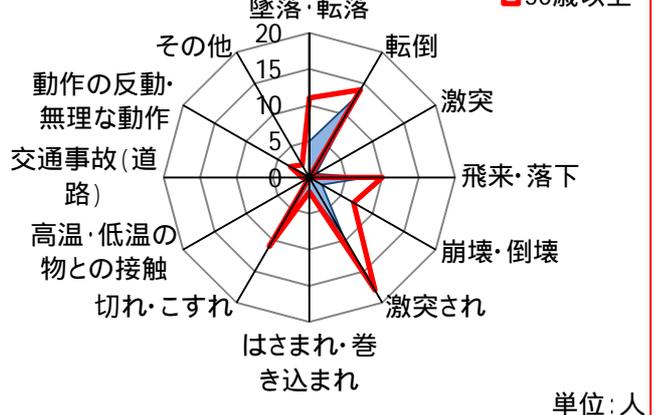
林業(50歳以上)では、**伐木作業時の激突され**災害と**転倒**災害が多く発生しています。
