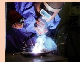
修理や据え付けといった屋外作業(現場作業)によく使われる溶接です。色々な継手の溶接方法を学びます。
