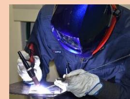
ステンレスの薄板で作られた板金製品や食品機械の部品の接合によく使われる溶接です。主にステンレスの色々な継手の溶接方法を学びます。
