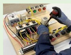
「シーケンス制御」とは、決められた順序通りに動く制御のことです。洗濯機や信号機、工場の生産ラインなど多くの分野で活用されています。スイッチやリレーと呼ばれる機器、ランプの間を電線で接続することで、ランプの点灯やモータ動作制御を行う「有接点シーケンス制御」を学びます。
