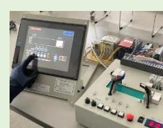
「PLC制御」とは、パソコンのソフトウェアを使ったプログラミングによる制御手法です。有接点シーケンス制御と比較して、複雑な制御が可能であり、動作の変更も柔軟に行える特徴があります。センサや数値を用いた制御や、タッチパネルによる操作制御を学びます。
